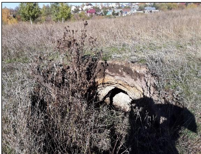
Фото № 6. Активизация карстово-суффозионного провала
